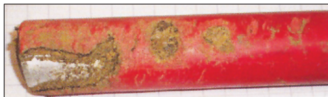
شکل ۱۴: صدمه کابل به وسیله موش صحرایی در کابل ۲۰ KV
