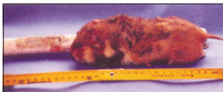
شکل ۱۴: صدمه کابل به وسیله موش صحرایی در کابل ۲۰ KV
